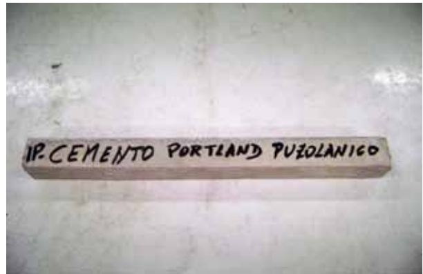
Barra de mortero con cemento portland puzolánico tipo IP después de 180 días de inmersión en sulfato de sodio; deformación final: 0,04 % de la longitud inicial, (la norma considera tolerable hasta 0,10 %)
