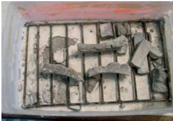
Barras de mortero con cemento portland ordinario (opc) después de 5 semanas en solución de sulfato de sodio (prácticamente se disolvieron)
