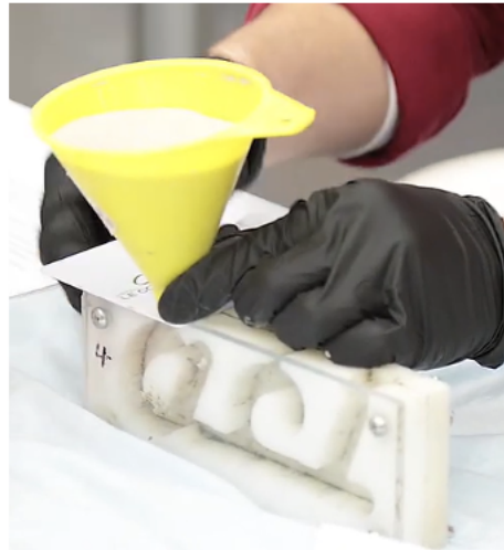
Figura 3. Ilustración aproximada de la prueba de Fluidéz
